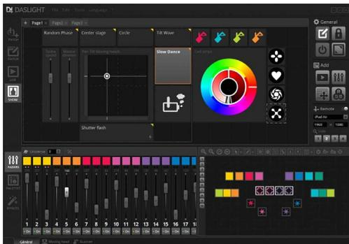
che è basato su interfaccia utente GUI. Il programma consente di *disegnare* con precisione certissima l'assetto delle luci di scena e stabilire per ogni proiettore quali siano intensità luminosa e, nel caso dei LED, miscelare colore ed effettistica. Oltre a consentire il controllo dell'acceso-spento dei tempi di transizione tra uno step e l'altro, può animare la scena
